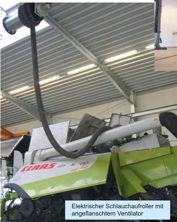
Elektrischer Schlauchaufroller mit angeflanschem Ventilator
